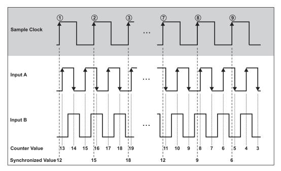
Fig. 199: Quadrature Encoder X2 Mode
