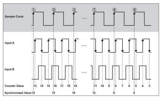
Fig. 192: Quadrature Encoder X2 Mode
