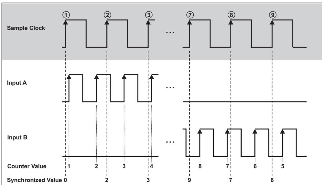
Fig. 215: A-Up/B-down encoder
