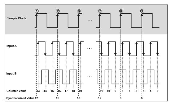
Fig. 199: Quadrature Encoder X2 Mode
