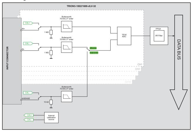
Fig. 99: Block diagram
