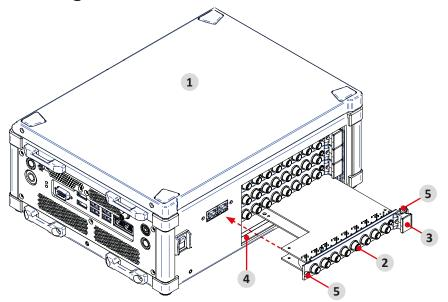
Fig. 2: Installing a TRION module
