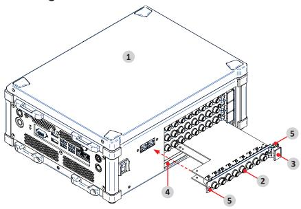
Fig. 2: Installing a TRION module
