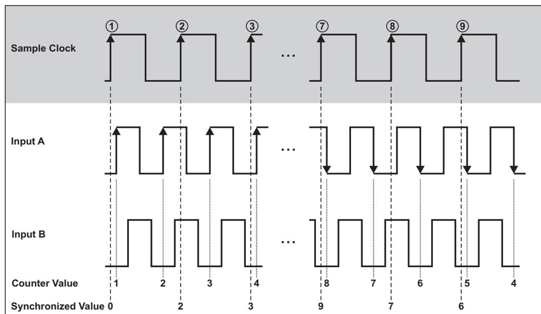
*Fig. 211: Quadrature Encoder X1 Mode*
