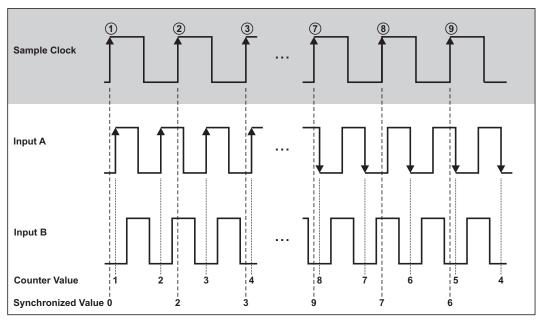
Fig. 198: Quadrature Encoder X1 Mode
