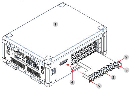
Fig. 2: Installing a TRION module
