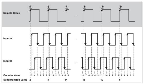
Fig. 193: Quadrature Encoder X4 Mode
