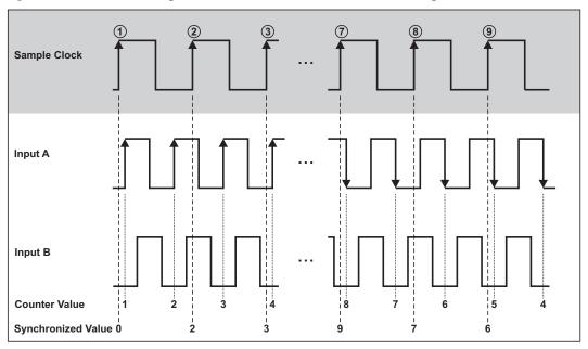
Fig. 191: Quadrature Encoder X1 Mode
