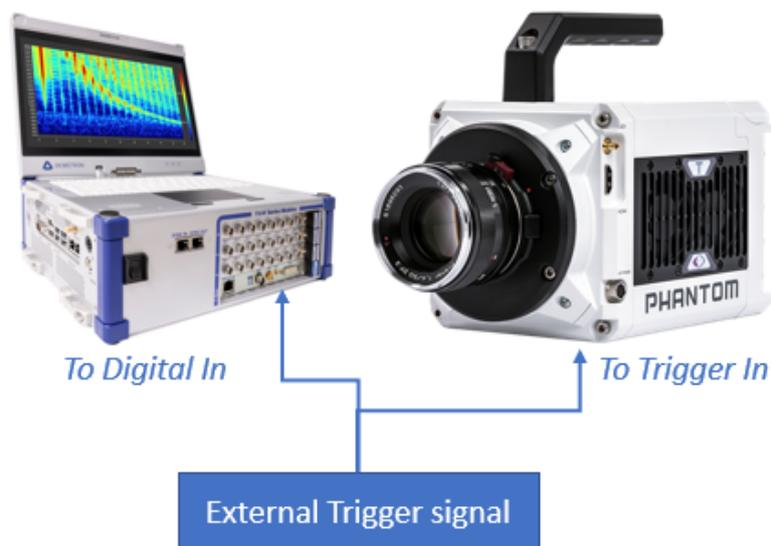
Abb. 7.164: Aufnahmestart von DAQ-System und Kamera, ausgelöst durch externes Signal
