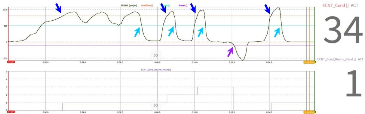
Abb. 7.55: ECNT-Funktion mit *Bedingung*, *Rearm* und *Reset*
