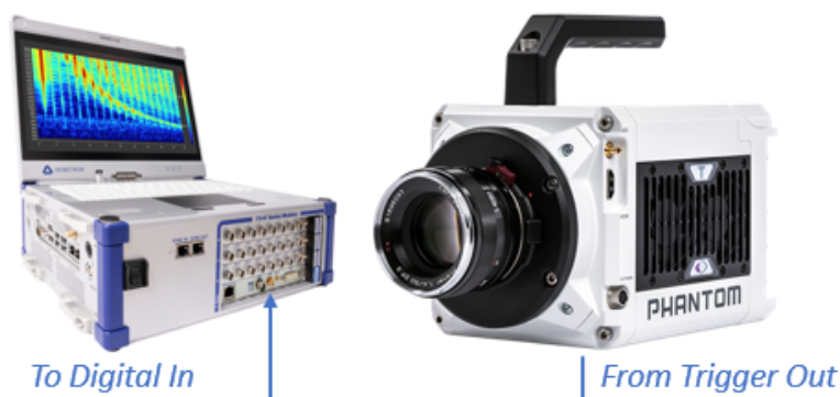
Abb. 7.163: Aufnahmestart des DAQ-Systems, ausgelöst durch Kamera
