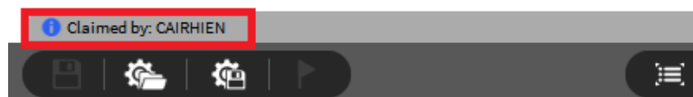
Abb. 15.13: Beanspruchte Informationen auf dem Slave-Gerät. In diesem Fall heißt das Master-Gerät CAIRHIEN
