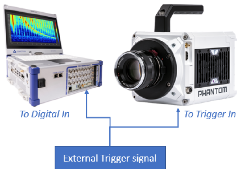
Abb. 7.162: Aufnahmestart von DAQ-System und Kamera, ausgelöst durch externes Signal
