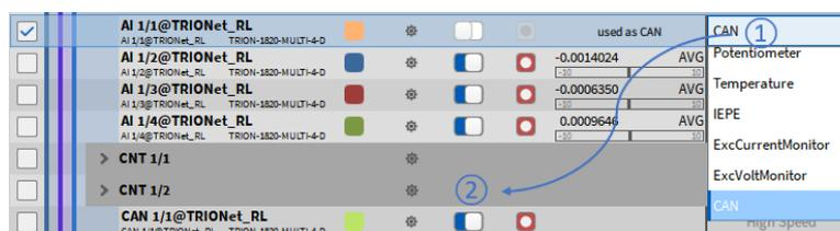
Abb. 7.203: CAN-Ports eines TRION-MULTI-Moduls
