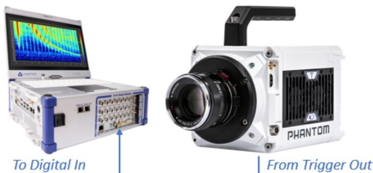
Abb. 7.165: Aufnahmestart des DAQ-Systems, ausgelöst durch Kamera
