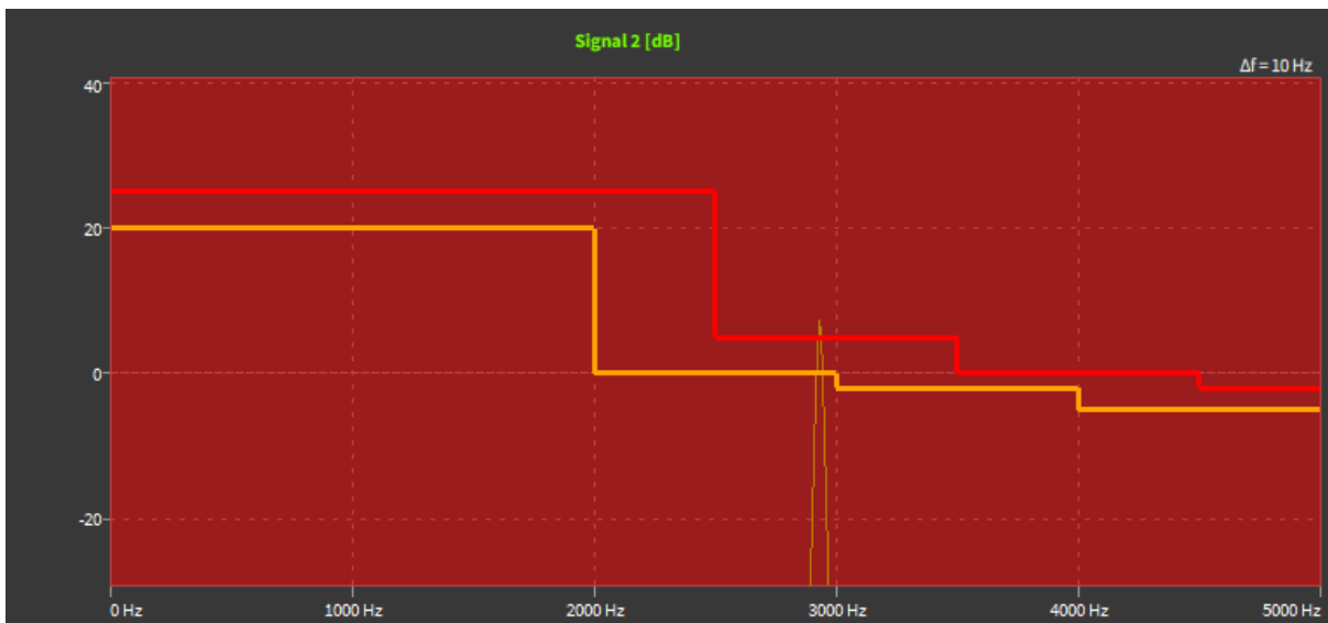
Abb. 8.73: Referenzkurve mit oranger und roter Limitüberschreitung
