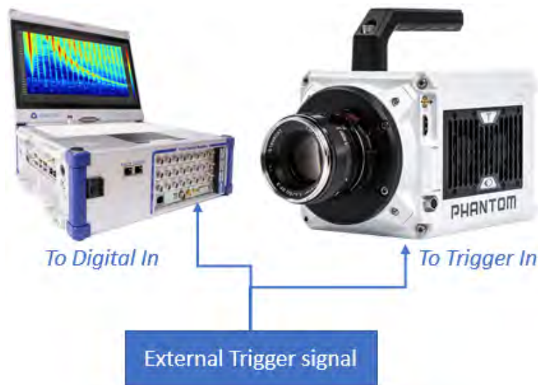
Fig. 7.162: 外部信号触发 DAQ 系统数据采集和相机录制启动
