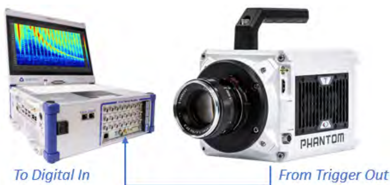
Fig. 7.163: 摄像头触发 DAQ 系统采集记录
