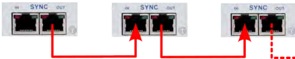
Fig. 15.14: 使用 TRION-SYNC-BUS 同步多个测量单元
