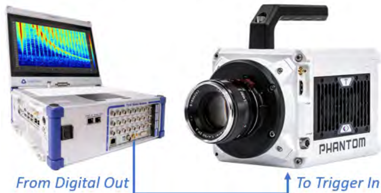
Fig. 7.164: DAQ 系统作为触发源启动相机视频录制
