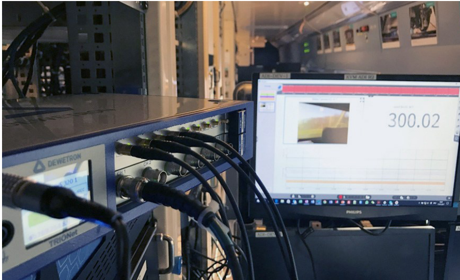
图 2: 高速列车测试中的 TRIONet3 与 OXYGEN
