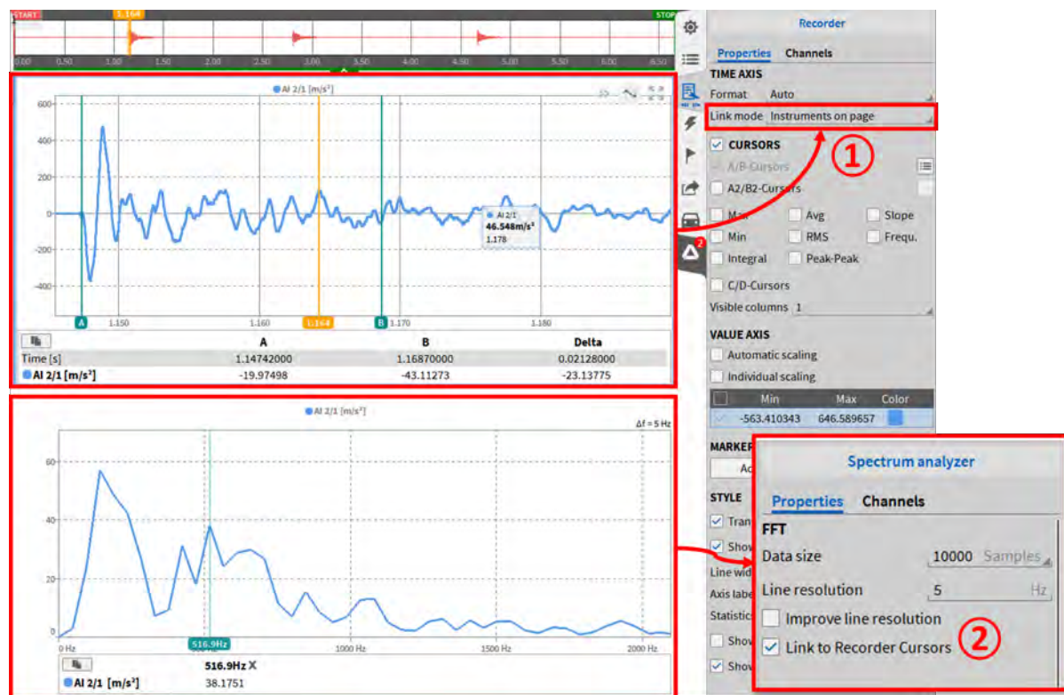
Fig. 8.66: レコーダ領域に基づくデータを含む Spectrum Analyzer
