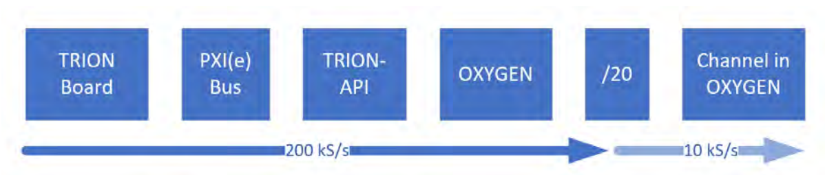
Fig. 7.38: チャンネル別サンプルレトリダクションの動作原理
