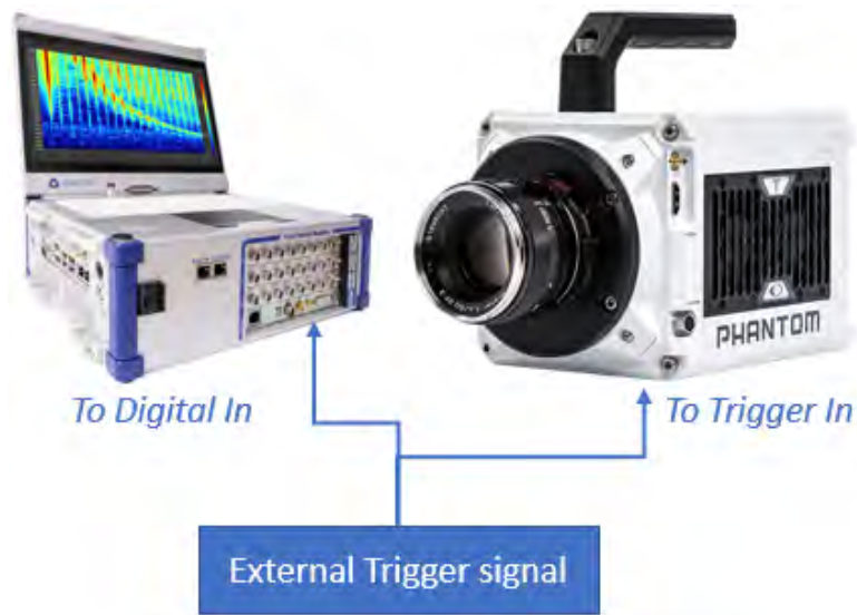
Fig. 7.162: 外部信号によってトリガーされる DAQ システムとカメラの記録開始
