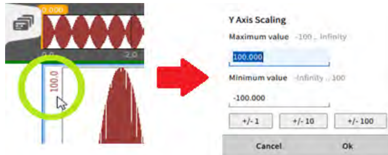
Fig. 8.20: 1つのチャンネルに対しカスタマイズしたY軸スケージングの定義（Individual Scaling がオフ）
