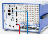
DEWE3-M8s mit integrierter PTP-Schnittstelle
