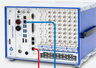
DEWE3-M8s mit integrierter PTP-Schnittstelle
