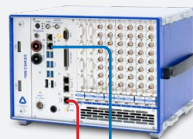
DEWE3-M8s mit integrierter PTP-Schnittstelle
