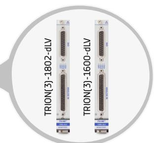
Konditionierte analoge ±5 V Signale
