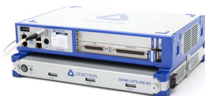
TRIONet3 mit DEWE-UPS-250-DC Akkupack für mobile, unabhängige Stromversorgung
