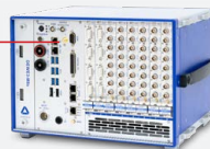
DEWE3-M8s mit integrierter GPS-Schnittstelle
